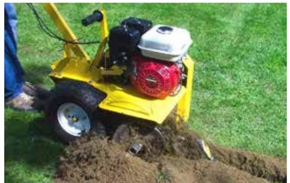
Seitlicher Erdbodenauswurf durch Förderschnecke.
