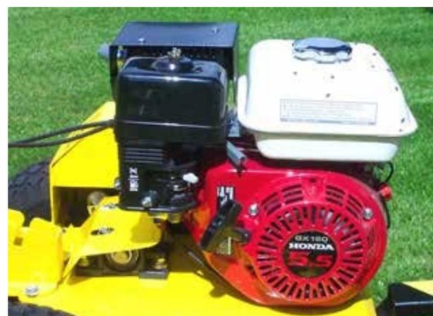
Die Maschine wird mit einem 5,5 PS Honda-Motor geliefert.
