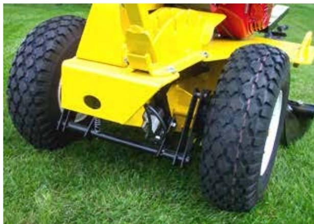
Die Räder werden blockiert, um ein selbsttätiges Fortlaufen der TR-12 Fräse zu verhindern.
