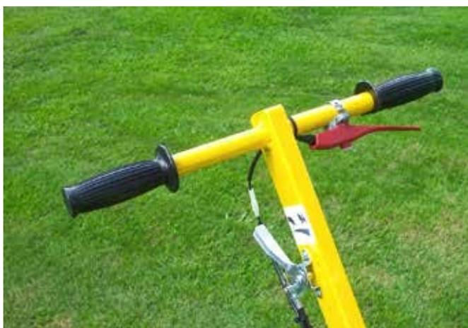
Die Fräse TR-12 ist mit einem Sicherheitshebel ausgerüstet, der den Motor sofort abschaltet, sobald der Bediener das Gerät verlässt.
